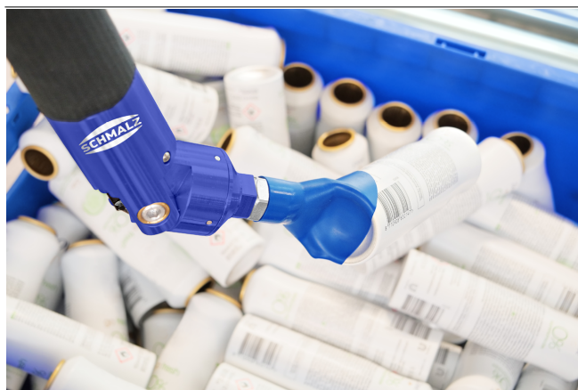
Schmalz Bin-Picker SBPG per la movimentazione delle bombolette spray di deodorante
